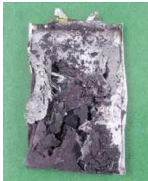
**Sichere Zelle:** Zahlreiche Berichte weisen auf ein hohes Gefahrenpotenzial beim Betrieb von Lithium-Sekundärbatterien aufgrund einer exothermen Reaktion des Elektrodenmaterials mit dem Elektrolyten bei Überspannung hin (siehe Bild einer explodierten Zelle). Ein Überzug der Elektroden durch eine Schicht aus  $\text{AlPO}_4$ -Nanopartikeln vermindert diese Risiken selbst bei Kurzschließen der Zelle signifikant.
